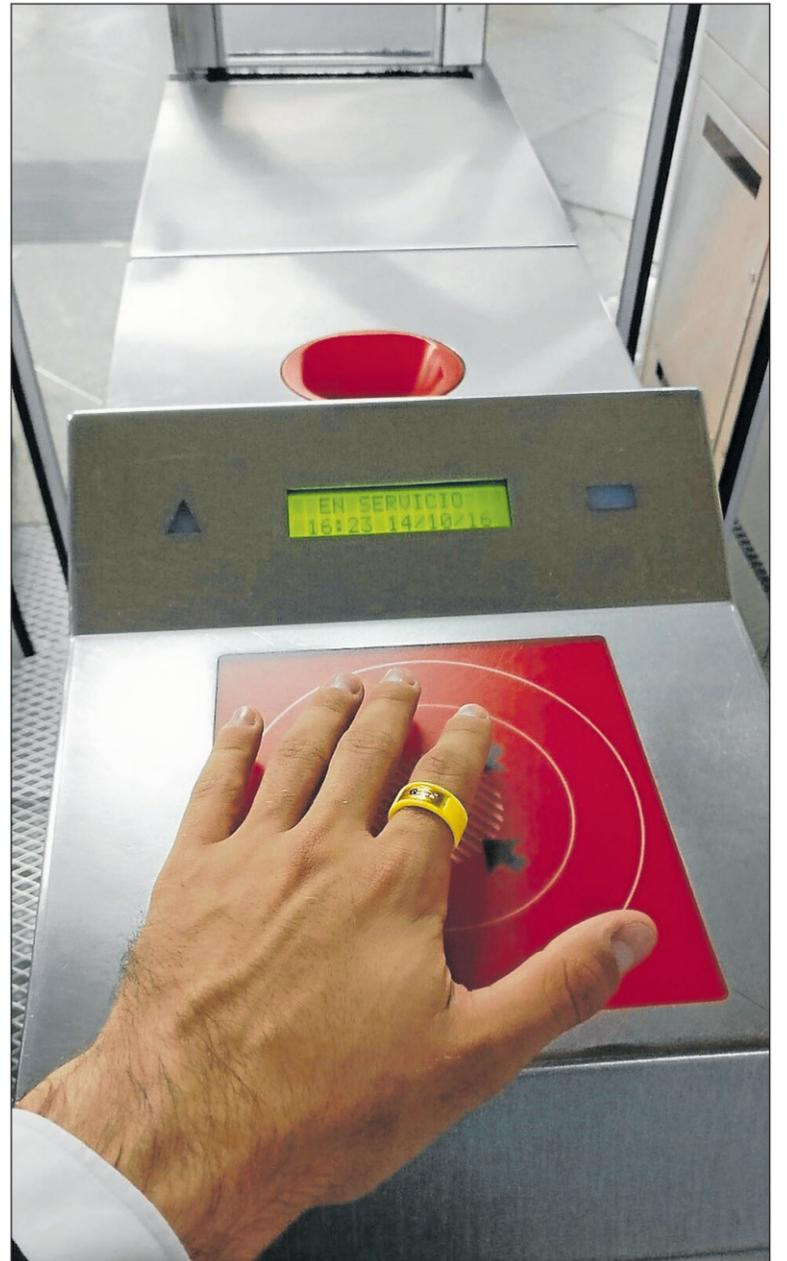
El prototipo se ha hecho a partir de una impresora 3D e incorpora una tarjeta NFC con la información de cada usuario. FOTO: DT
